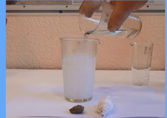
Заливая воду, готовим 10%-й раствор РР
