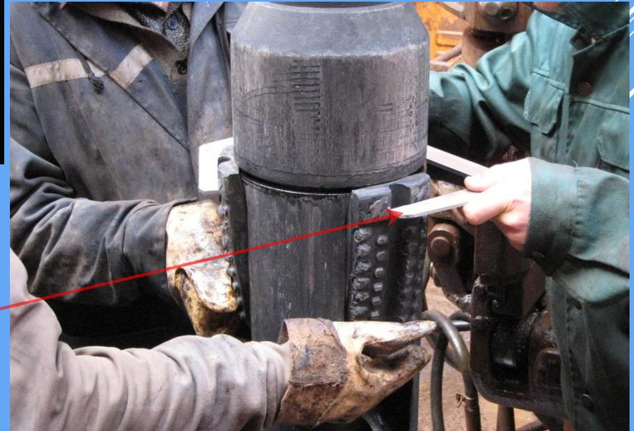
Замер диаметра в рабочем положении
